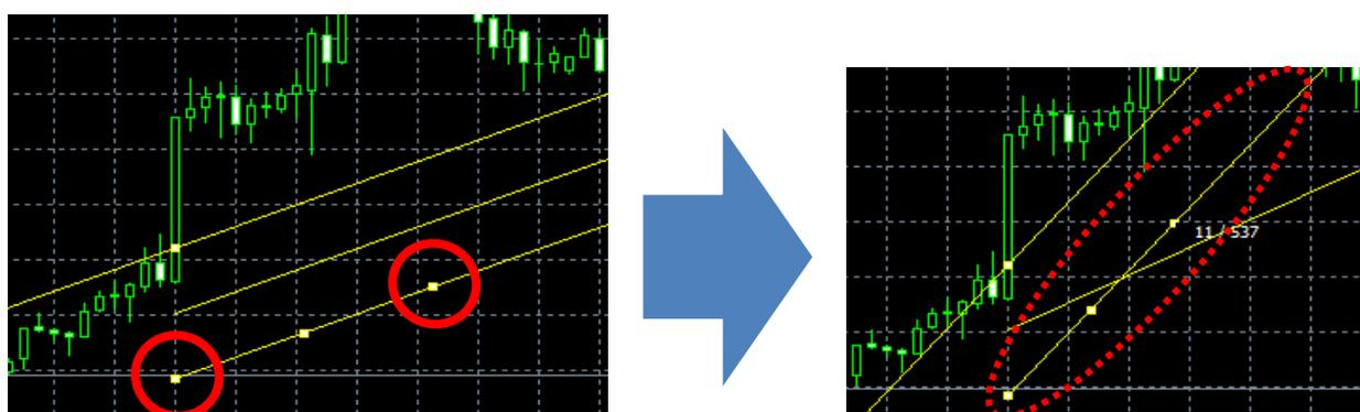
7 マークが1つだけの箇所をドラッグすると平行チャネルの幅が変更できます。
